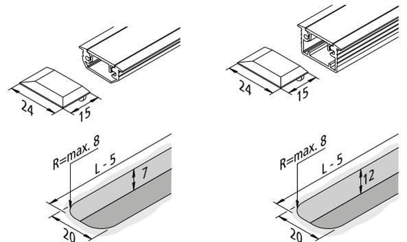
• Einfräsprofil zur symmetrischen Ausleuchtung
