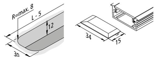
• Einfräsprofil zur symmetrischen Ausleuchtung
